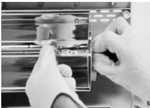
5. SCOATEȚI CELE DOUĂ CAPSULE ELASTO-TERMICE DE LA EXTREMITĂȚILE LĂMPII ȘI DECONECTAȚI CEI DOU CONECTORI FASTON CARE LEAGĂ FIRELE LĂMPII (ÎN CAZUL UZURII, ACESTEA TREBUIE ÎNDEPĂRTATE PRIN TĂIERE PÂNĂ LA CEI DOI CONECTORI FASTON).
