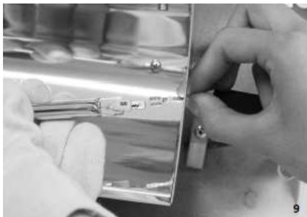
9. LEGAȚI CONECTORII FASTON MASCULI AI NOII LĂMPI LA CELE DOUĂ FIRE. ACOPERIȚI CU CELE DOUĂ CAPSULE ȘI REAȘEZAȚI LAMPA ÎN LOCUL CELOR DOUĂ CLEME ELASTICE. NU ATINGEȚI LAMPA CU MÂINILE GOALE.
